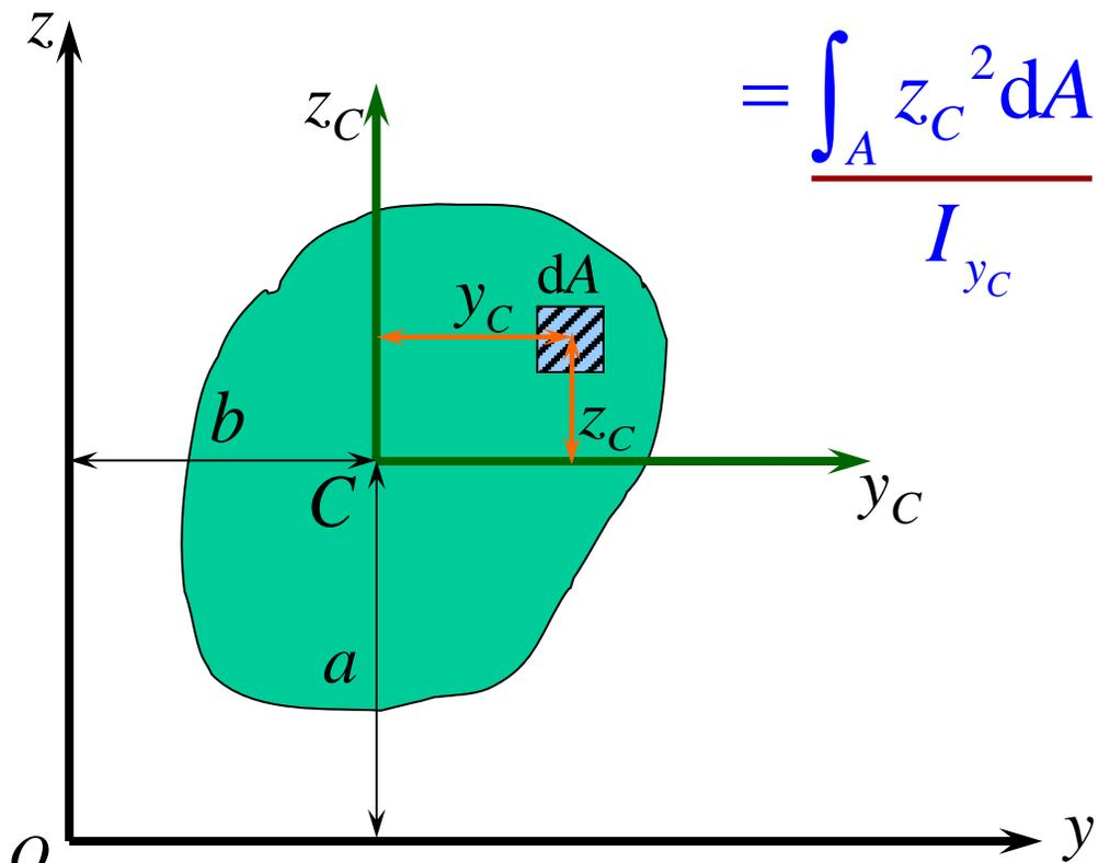
同一平面内对所有相互平行的坐标轴的惯性矩, 对形心轴的最小。
