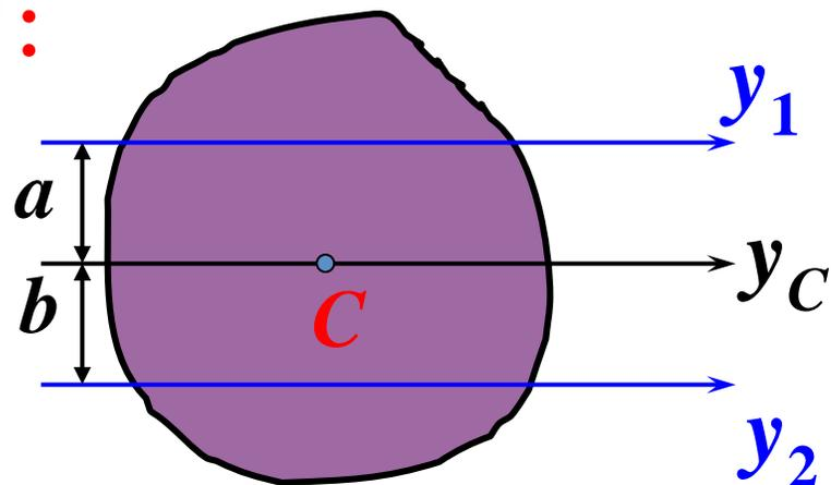
已知平面图形面积为 $A$ ， $y_C$ 轴过形心， $y_C$ 、 $y_1$ 、 $y_2$ 三轴平行。若图形对 $y_1$ 轴的惯性矩为 $I_{y_1}$ ，则
