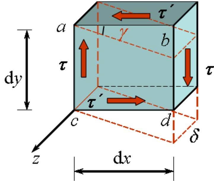
试根据切应力互等定理，判断图中所示的各单元体上的切应力是否正确。
